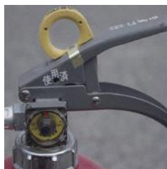
× 表示装置の脱落
