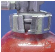
× キャップの破損
