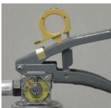
× 安全栓の抜けかけ
