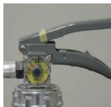
× 安全栓の脱落
