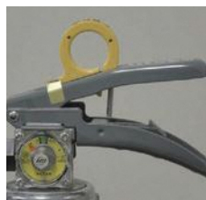
× レバー支えの脱落
